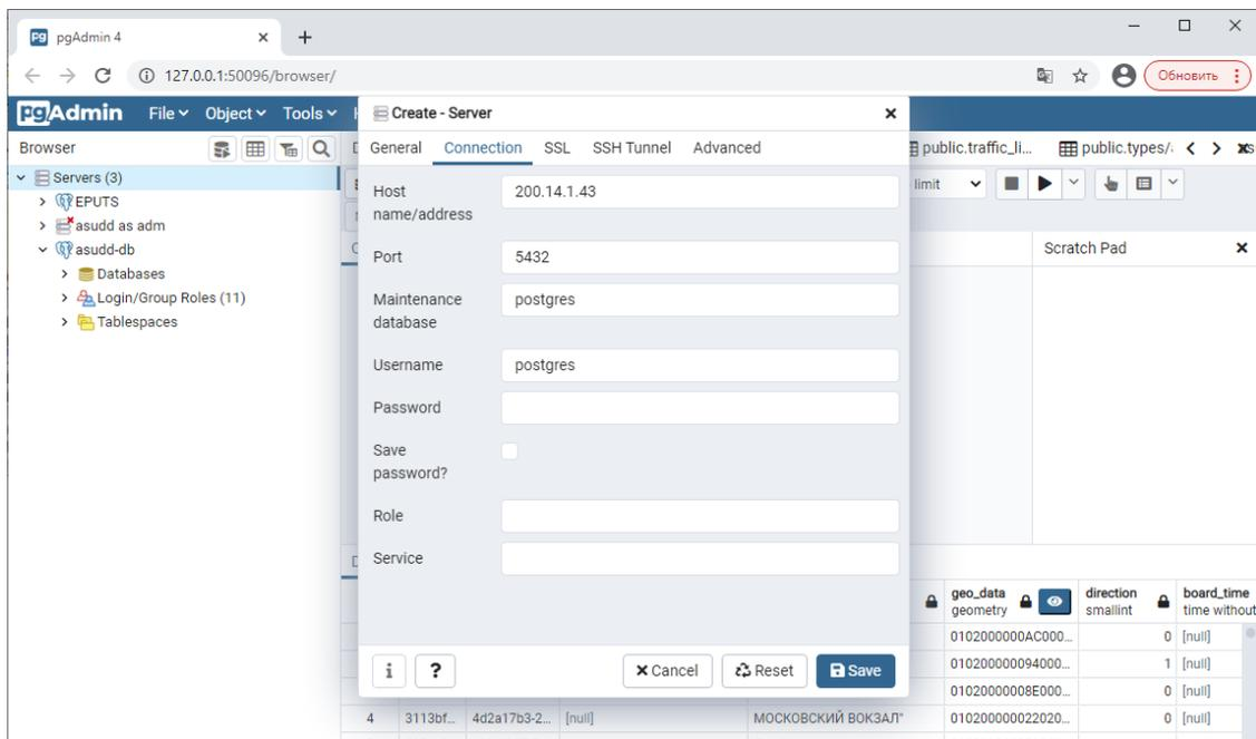
Рисунок 2. Подключение к базе данных из pgAdmin4
